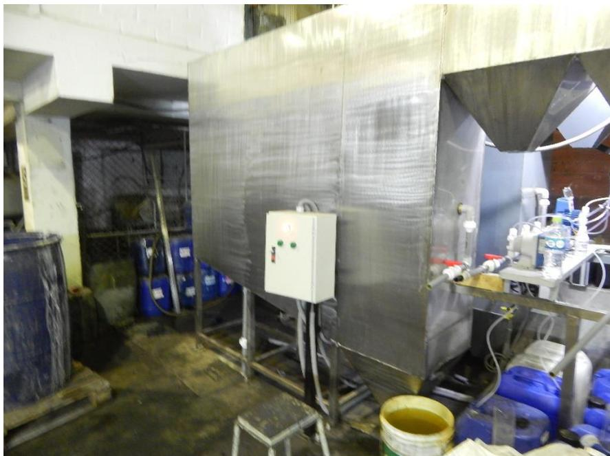
**Figura 14:** Vista del sedimentador lamelar construido de planchas de acero inoxidable que trabaja a pH de 11 unidades.
