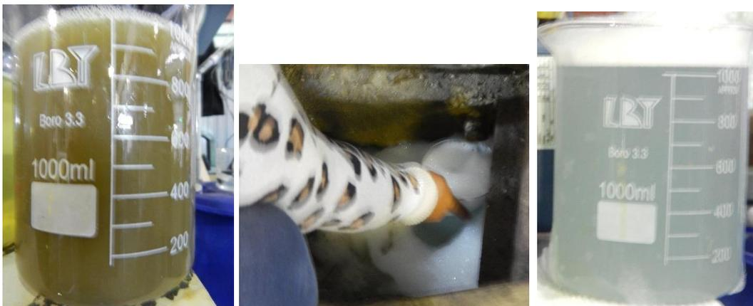
**Figuras 20, 21 y 22:** La primera vista muestra el efluente crudo que ingresa al sistema de tratamiento, mientras que la segunda corresponde a la toma de muestra de la propia alcantarilla donde se están descargando el efluente tratado por el sistema, mientras la tercera vista se aprecia la calidad del efluente tratado, el cual cumplió con la calidad esperada de los VMA.
