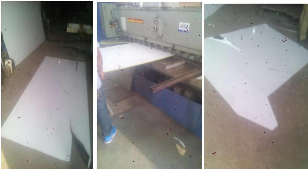
**Nota:** Plancha de acero inox, durante el corte por guillotina
