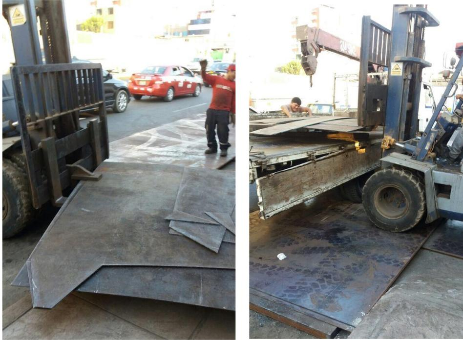
**Figuras 7 y 8:** Maniobras de izaje de las planchas cortadas, para su traslado al taller de soldaduras
